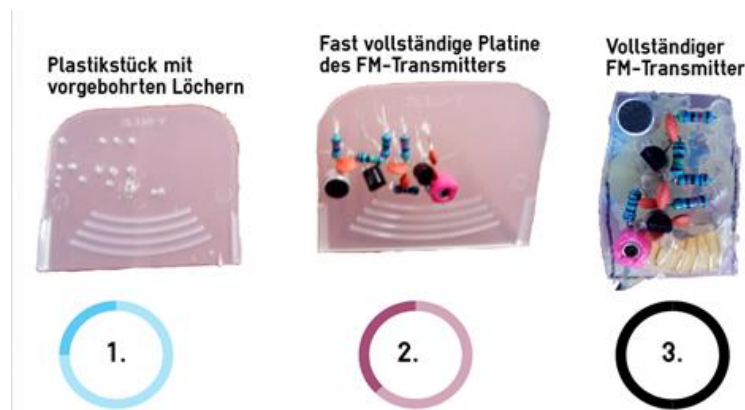
Bild: Verschiedene Schritte des FM-Transmitterbaus; Elias Mitropoulos; Q: 19
