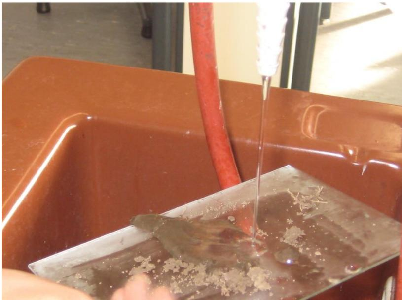
Bild: Schmutz perlt auf der Scheibe von Silikon und Paraffin mit Shellsol gut ab; Elias Mitropoulos
